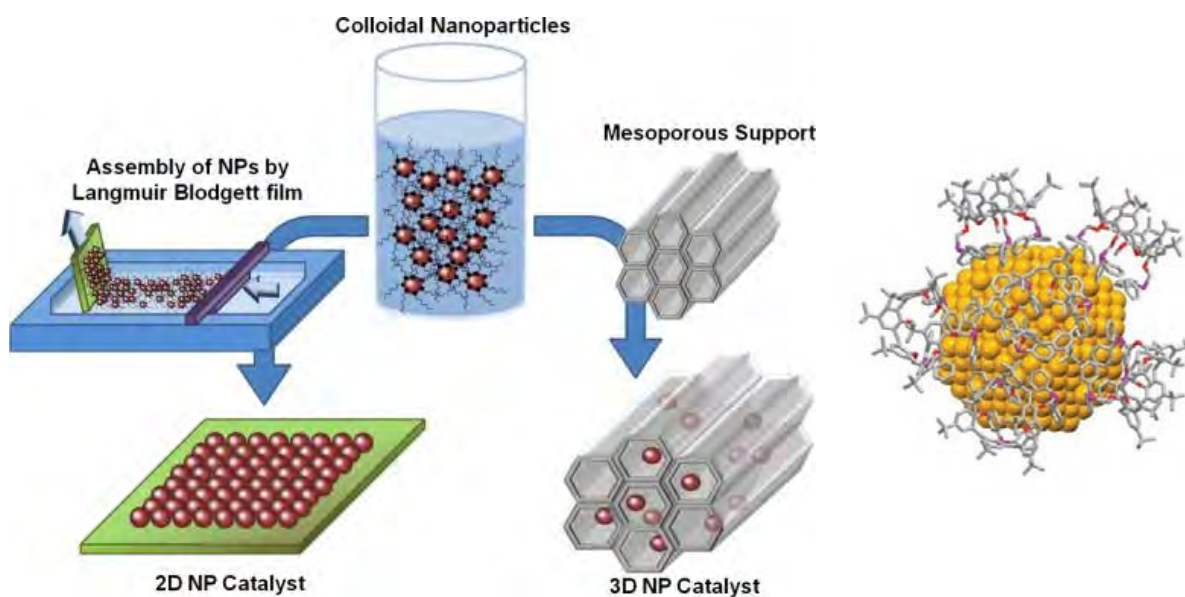
Schema obținerii și structura nanoparticulelor de catalizatori 2-D și 3-D
